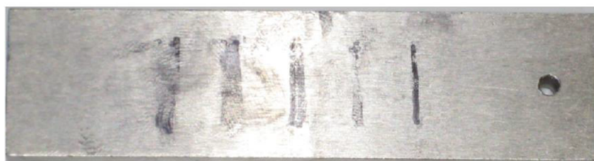
Рис. 5. Дефектограмма искусственных дефектов на образце МО-3
