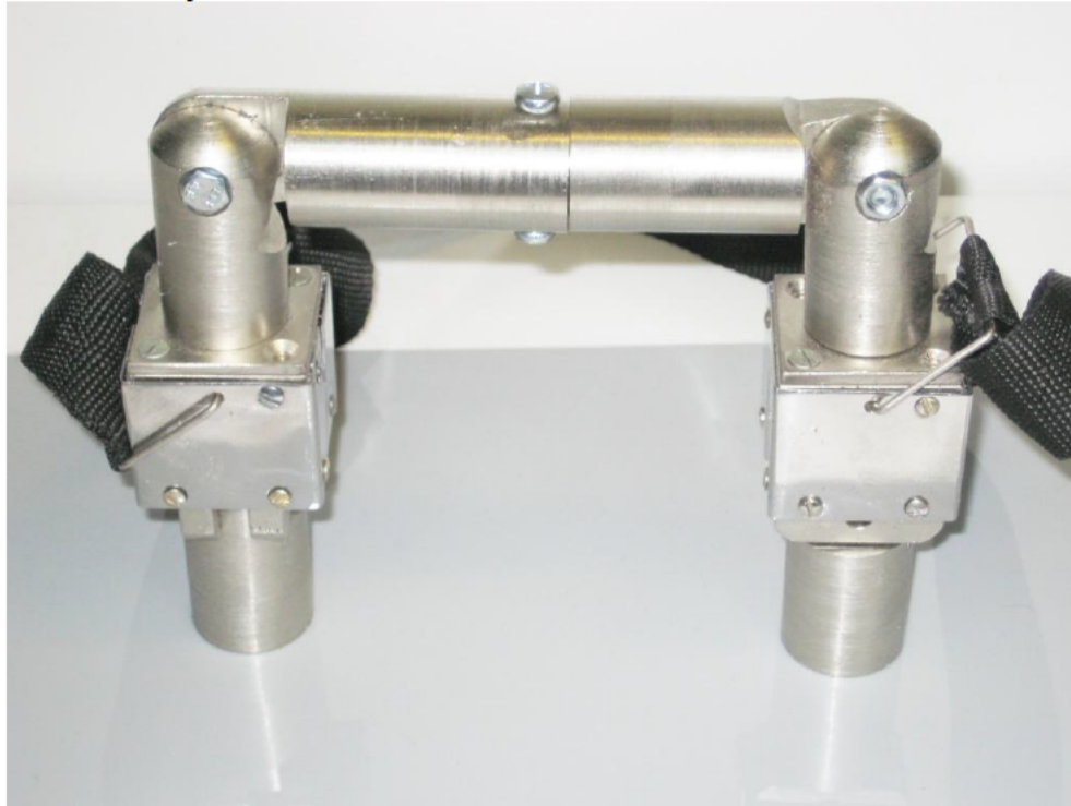
Рис.2. Намагничивающие блоки, соединенные шарнирным магнитопроводом, на проверяемой детали
