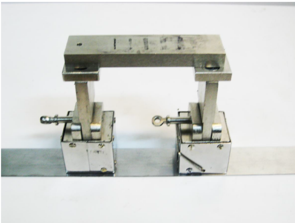
Рис.4. Положение образца МО-3 в намагничивающих блоках при проверке работоспособности дефектоскопа и качестве суспензии
