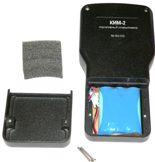
Рис. 1-3. Прибор со снятой крышкой аккумуляторного отсека
