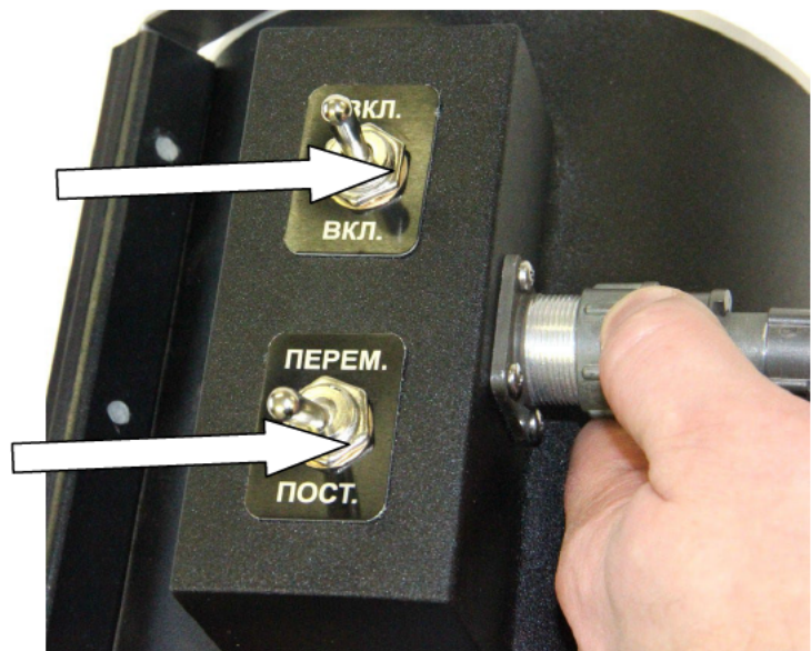
Рис. 5.6 Подключение провода и управление соленоидом
