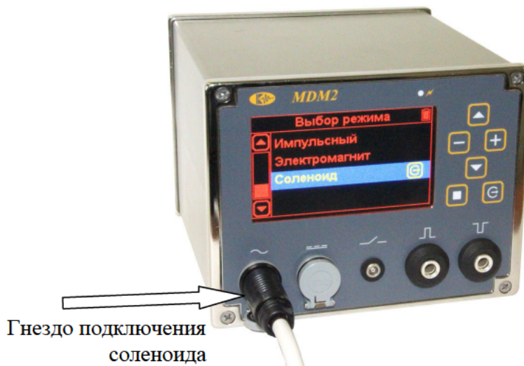
Рис. 5.5 Подключение соленоида к дефектоскопу
