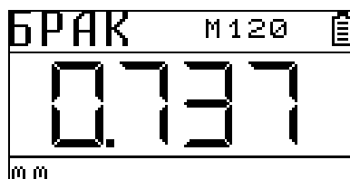
Рис.4-3 Срабатывание визуальной сигнализации брака
