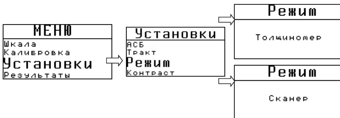
Рис.2-9 Выбор режима измерения толщины
