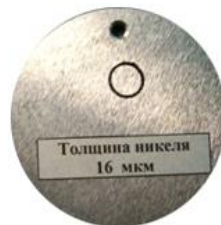
Натурная мера толщины металлического покрытия на образцовом основании (электролитический никель толщиной h_{\max} = 16 \text{ мкм} )
