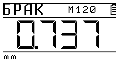
Рис.4-3 Срабатывание визуальной сигнализации брака
