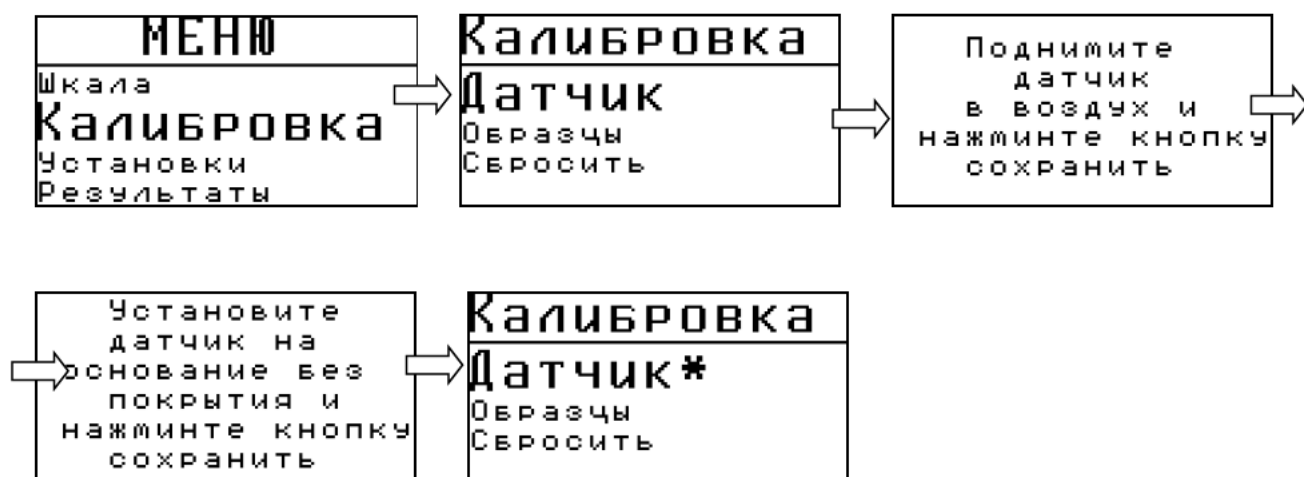
Рис.2-6 Последовательность действий при калибровке нуля на чистом основании
