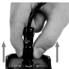
Рисунок 4. Подключение (а) и отключение (б) провода заземления
