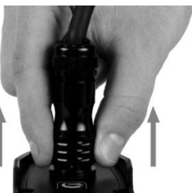
Рисунок 3. Подключение (а) и отключение (б) высоковольтной рукоятки
