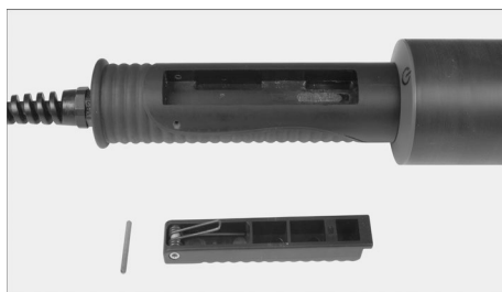
Рисунок 25. Последовательность действий при снятии клавиши «Контроль»: откручивание винта крепления клавиши (а), высоковольтная рукоятка со снятой клавишей (б)
