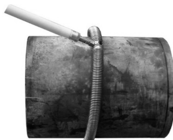
Рисунок 21. Подготовленный к проведению контроля пружинный электрод в сборе с захватом и удлинителем
