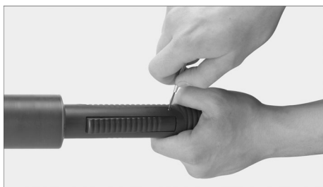
Рисунок 25. Последовательность действий при снятии клавиши «Контроль»: откручивание винта крепления клавиши (а), высоковольтная рукоятка со снятой клавишей (б)
