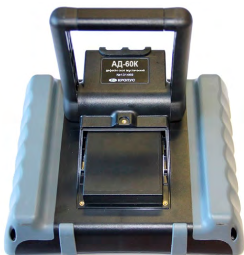
Рис 1-2 Прибор со снятой крышкой аккумуляторного отсека
