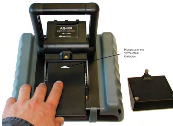
Рис 1-4 Установка нового аккумулятора
