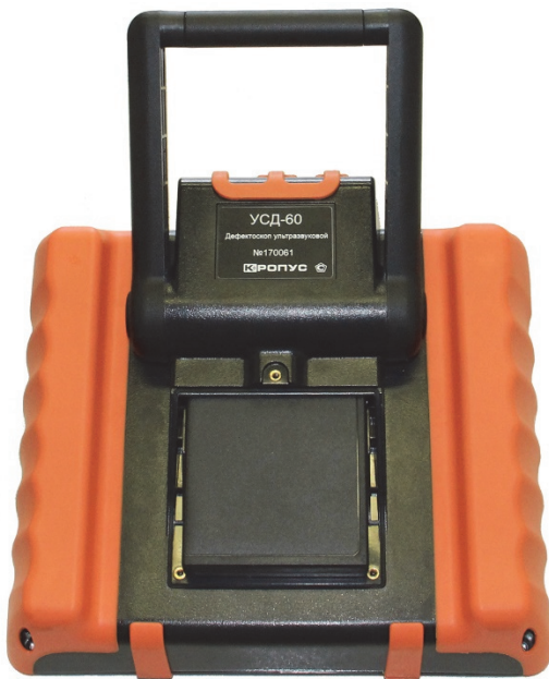
Рис.1-2 Прибор со снятой крышкой аккумуляторного отсека
