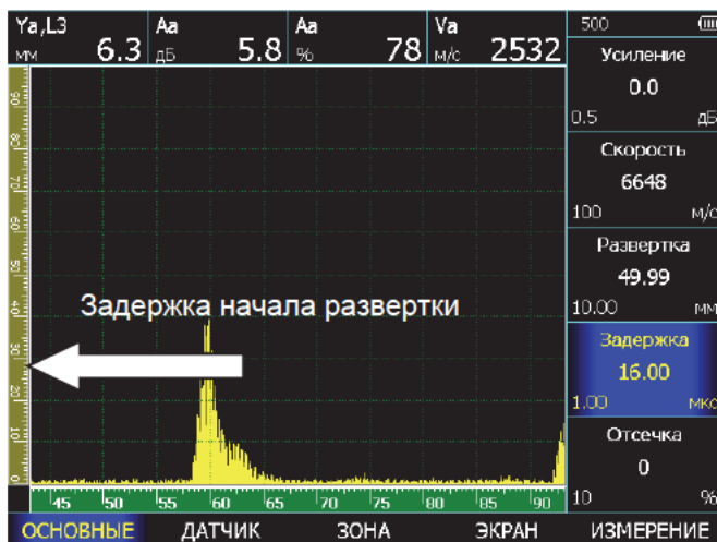
Рис.2-12 Изменение задержки начала развертки
