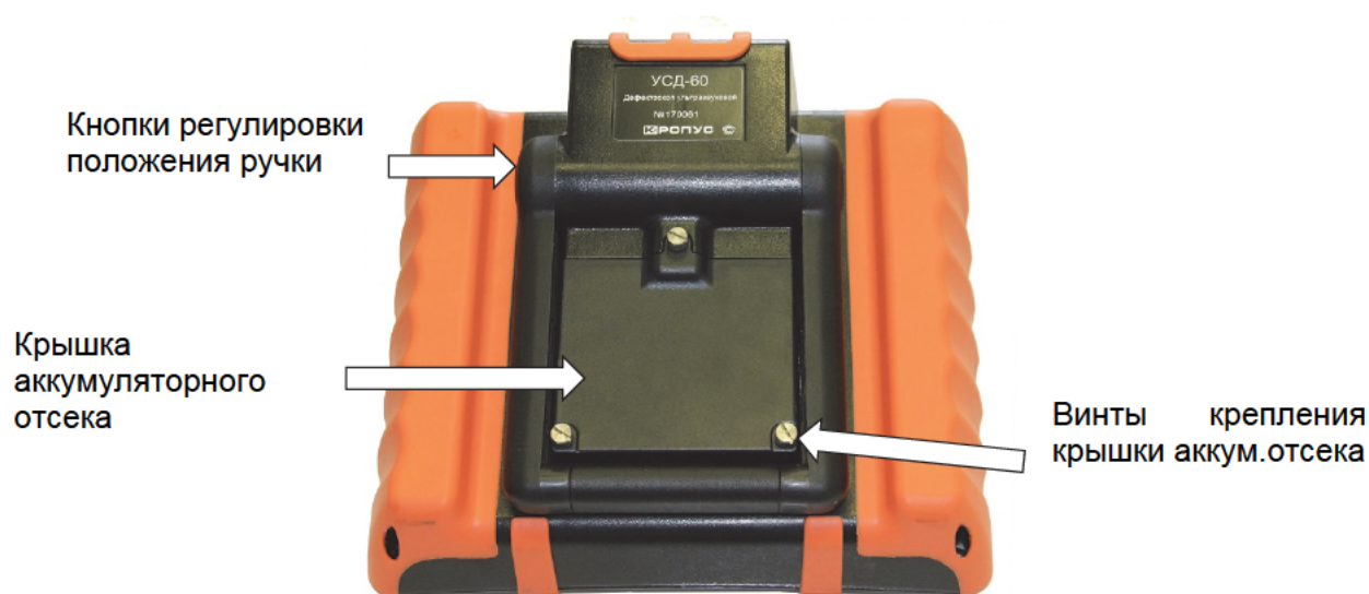
Рис. 1-1 Вид прибора сзади
