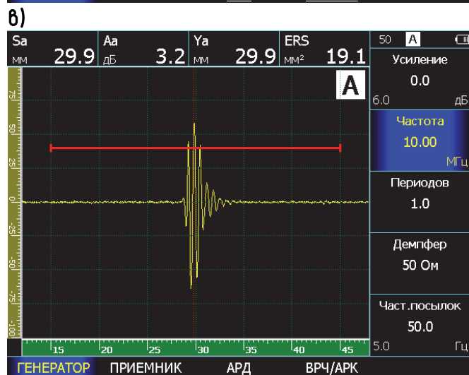
Рис. 2-6 Результат регулировки частоты зондирующего импульса (датчик 111-5-K12) а) 2,5МГц – малая частота, падение амплитуды и искажение формы сигнала б) 5МГц – оптимальная частота в) 10МГц – слишком высокая частота заполнения, падение амплитуды сигнала
