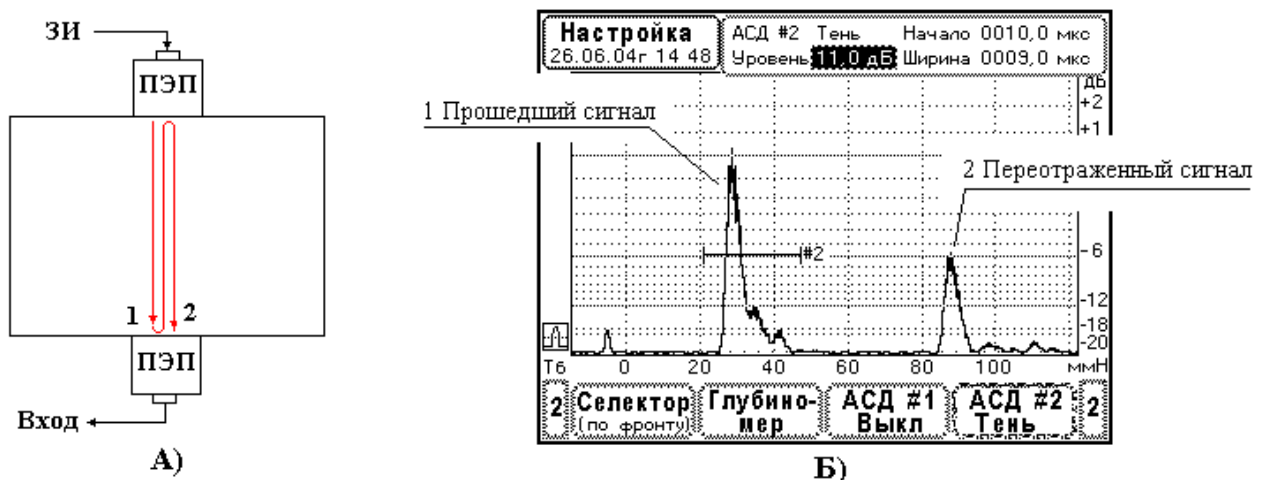
Рис. 9.4.11.2. Настройка строба АСД#2 для контроля листов теневым методом.
