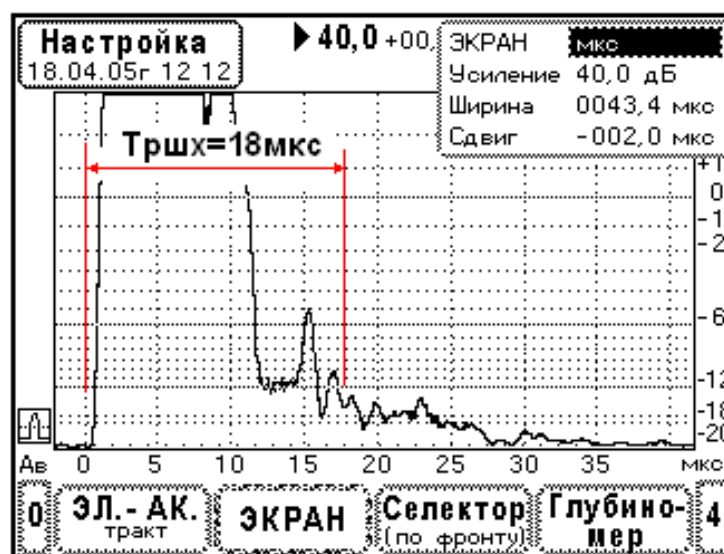
Рис. 10.6.13.1. Определение длительности РШХ. Преобразователь П121-2,5-40°- \varnothing 14.
