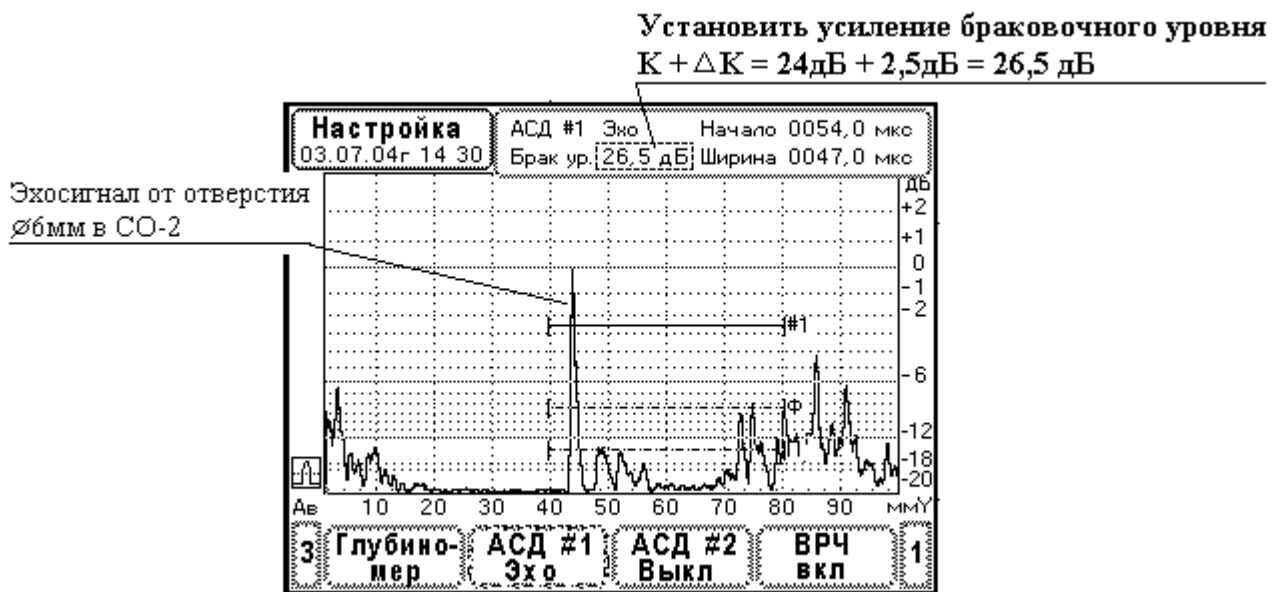
Рис. 9.4.15.3. Установка браковочного уровня АСД#1.
