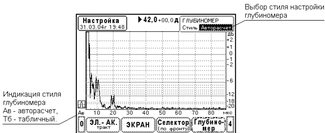
Рис. 9.4.4.1. Выбор стиля настройки глубиномера.
