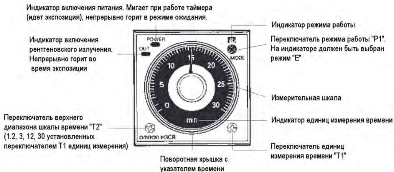
Рисунок 2а – Описание органов управления таймера экспозиции
