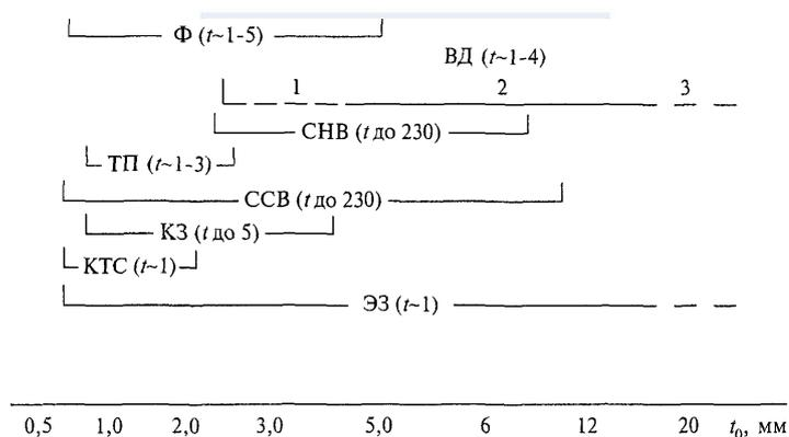
Ф - фальцовка; ВД - дюбель высокопрочный (1, 2 и 3 - соответственно "легкий", обыкновенного качества и высшего качества); ССВ - самосверлящий винт; СНВ - самонарезающий винт; КЗ - комбинированная заклепка; КТС - контактная точечная сварка; ЭЗ - электрозаклепки
