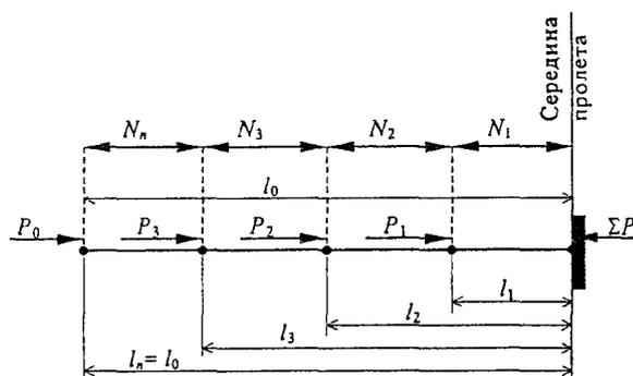
Рисунок А.1. Расчетная схема сжатых участков пояса фермы
